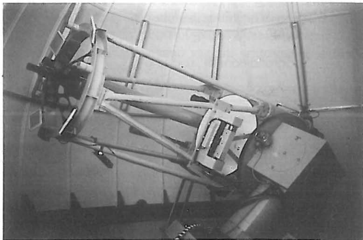
Il riflettore Cassegrain da 76 cm dello Sphinx
