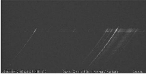
*Figura 1. Spettro della meteora sporadica apparsa il 12 ottobre 2016 alle 03:31:35 UT. Dati: reticolo di 600 linee/mm; lente Panasonic 8 mm f/0.75, camera Watec 902H2 Ultimate.*
