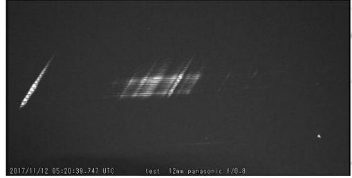
*Figura 3. Spettro della meteora sporadica apparsa il 12 novembre 2017 alle 05:20:39 UT. Dati: reticolo di 300 linee/mm; lente Panasonic 12 mm f/0.8, camera Watec 902H2 Ultimate.*
