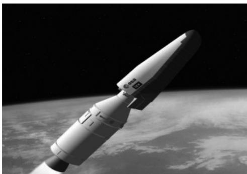
*Ma cosa è esattamente IXV? Si tratta di un veicolo spaziale sperimentale - delle dimensioni di un automobile e il peso di circa 2 tonnellate - in grado di compiere un rientro atmosferico controllato dall'orbita terrestre bassa. Ha una forma non convenzionale, di un tipo definito "lifting-body", caratterizzata dalla grande manovrabilità e aerodinamicità.*
