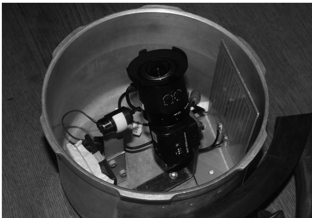
L'apparecchiatura alloggiata nella pentola: la videocamera, la termoresistenza (sulla destra), la ventola (in basso a sinistra), il motorino (a sinistra della videocamera). Mancano i sensori di umidità, di temperatura, la copertura in alluminio, i granuli dissecanti e i cablaggi.
