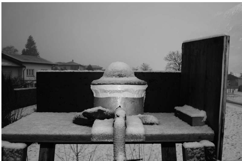
La pentola chiusa e in posizione definitiva dopo una leggera nevicata. Una camera d'aria è stata collegata esternamente per accogliere l'aumento di volume dell'aria durante le calde giornate estive. In questo modo la pressione interna viene mantenuta pressoché costante.
