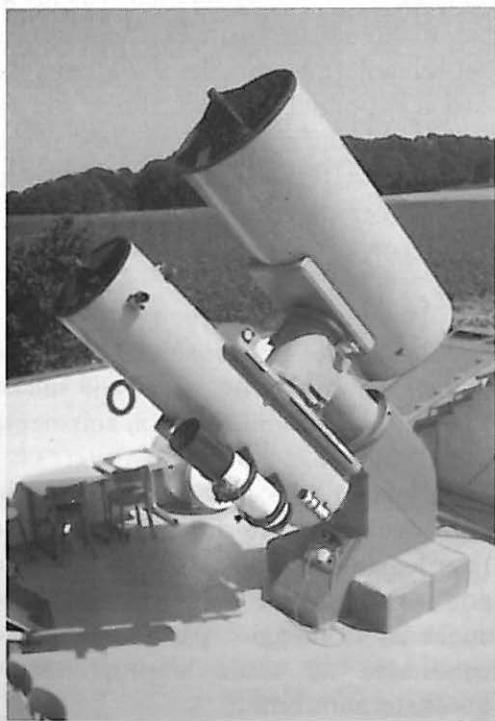
metri di focale e in parallelo troviamo un Meade SN8 da 20cm f/4 utilizzato quasi esclusivamente con la camera CCD in loro dotazione. Con i dieci oculari da 2 pollici di diametro, usati solo per gli strumenti più grossi, si possono avere da 14 a 1136 ingrandimenti. Il tutto è fissato su una montatura equatoriale poggiata su uno zoccolo di cemento armato di 5 tonnellate indipendente dal terrazzo (vedi foto in questa pagina).
