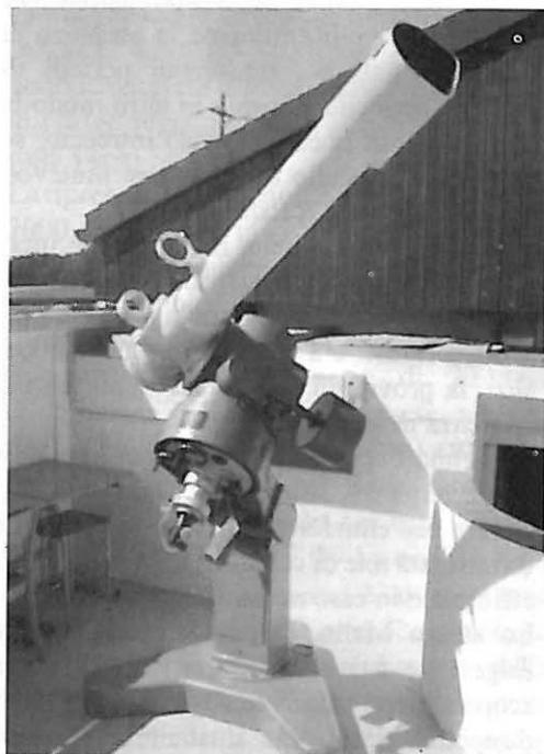
*Il rifrattore-coudé Zeiss da 15 cm*
