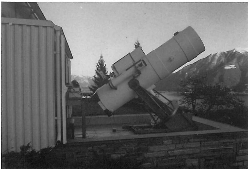
*In alto : la cupola della Specola Solare Ticinese di Locarno Monti vista da sud. In essa sono installati sulla stessa montatura Zeiss : un rifrattore da 150 mm (per l'osservazione solare) e un riflettore da 250 mm (per l'osservazione planetaria).*
