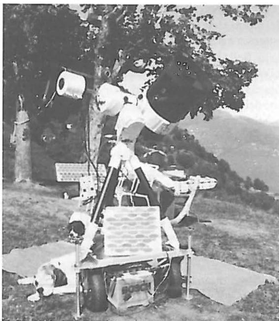
*La montatura mobile piazzata sul terreno, Monti di Purera (1041 ms/m) a Ronco s/A. Si scorgono la batteria e il pannello solare.*
